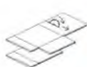
3. AUSGEBAUTE BATTEN ZUSCHNEIDEN
